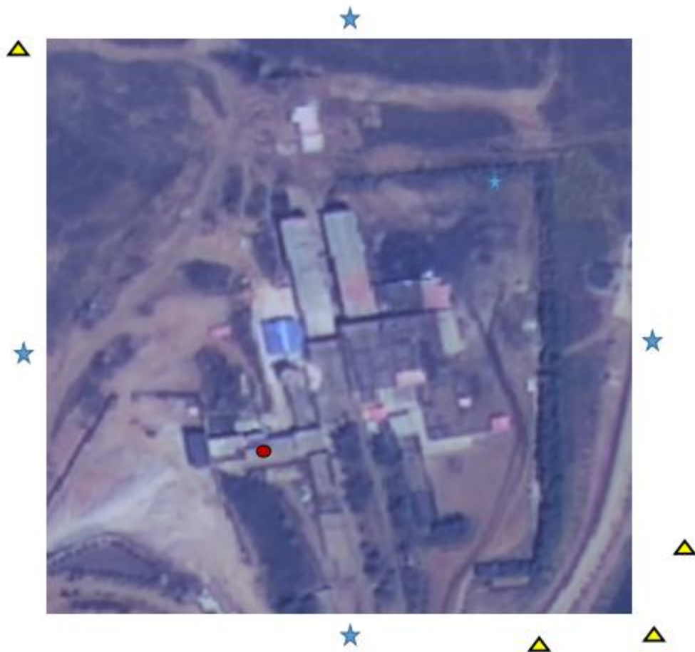
图例：▲无组织废气检测点位 ●破碎筛分废气检测点位 ★噪声检测点位
